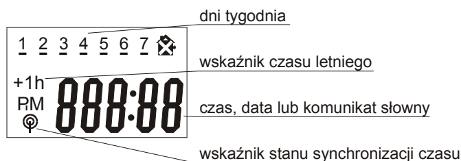
Rys. 2 Wygląd i opis wyświetlacza programatora ttc Prog.
